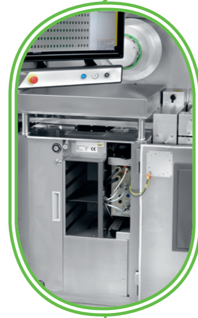
Die X-Ray-Baugruppe ist kompakt und sicher in die Blistermaschine SSP2 integriert. Die Steuerung erfolgt komfortabel über das HMI-Bedienpanel.
