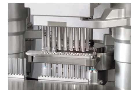
Präzise Dosierung von Pellets in den XStraw® mit Technologie von Harro Höfliger.
