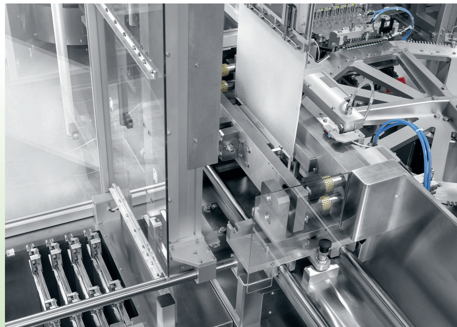
Das Ausstanzen und Einsetzen der mit IgE-Liquid getränkten Vliesschwämmchen in die Caps erfolgt parallel.
