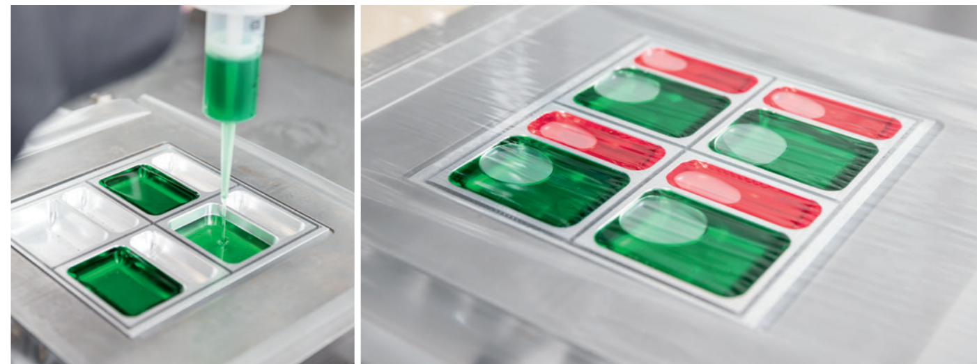
Links: Die PVOH-Folie wird in Form tiefgezogen, dann werden die Kammern mit den verschiedenen Medien wie Pulver, Gel oder Flüssigkeit sauber befüllt. Rechts: Nach der Wassersiegelung von Deck- und Bodenfolie werden die Mehrkammerpackungen ausgestanzt oder ausgeschnitten.
