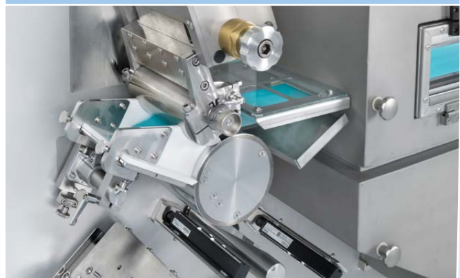
Zwei Beschichtungssysteme Comma Bar (oben) und Slot Die (seitlich)
