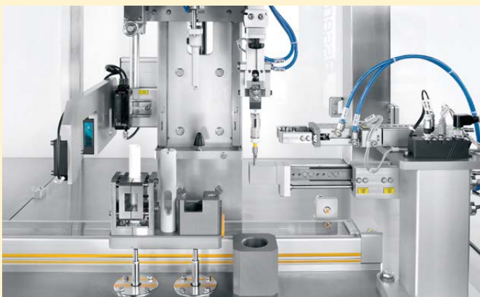
Die Endmontage kann bei kleineren Serien auf dem halbautomatischen Montagesystem Assembly Lab erfolgen.
