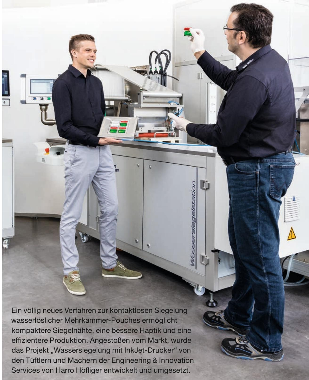
Ein völlig neues Verfahren zur kontaktlosen Siegelung wasserlöslicher Mehrkammer-Pouches ermöglicht kompaktere Siegelnähte, eine bessere Haptik und eine effizientere Produktion. Angestoßen vom Markt, wurde das Projekt „Wassersiegelung mit InkJet-Drucker“ von den Tüftlern und Machern der Engineering & Innovation Services von Harro Höfliger entwickelt und umgesetzt.
