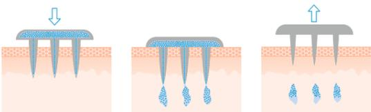
Hohle Mikronadeln (HM) sind für die Verabreichung höherer Wirkstoffdosen vorgesehen. In die Nadeln aus Edelstahl werden dazu Kanäle gebohrt, beispielsweise mit einem Laser. Die auf der Trägerfolie in einem Reservoir enthaltene Wirkstofflösung gelangt durch die Hohlnadeln in die Haut.
