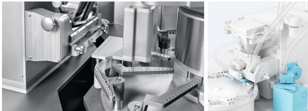
Die vollautomatische Kalibrierung macht Prozesse bei der Kapselbefüllung sicherer.
