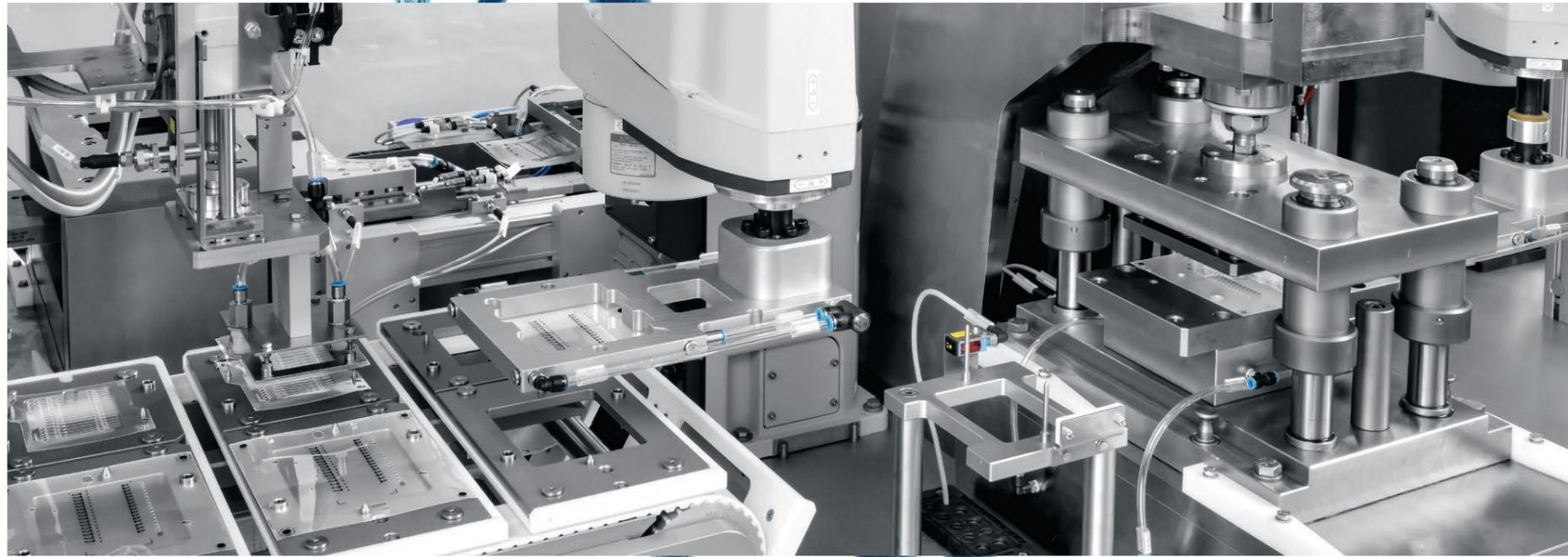
Die von Harro Höfliger entwickelte Maschine führt die zwei aus Folienmaterial bestehenden Hauptkomponenten des ScreenTapes passgenau zusammen: den mit Elektrodenanschlüssen bedruckten Printed Layer und den thermogeformten Process Layer.
