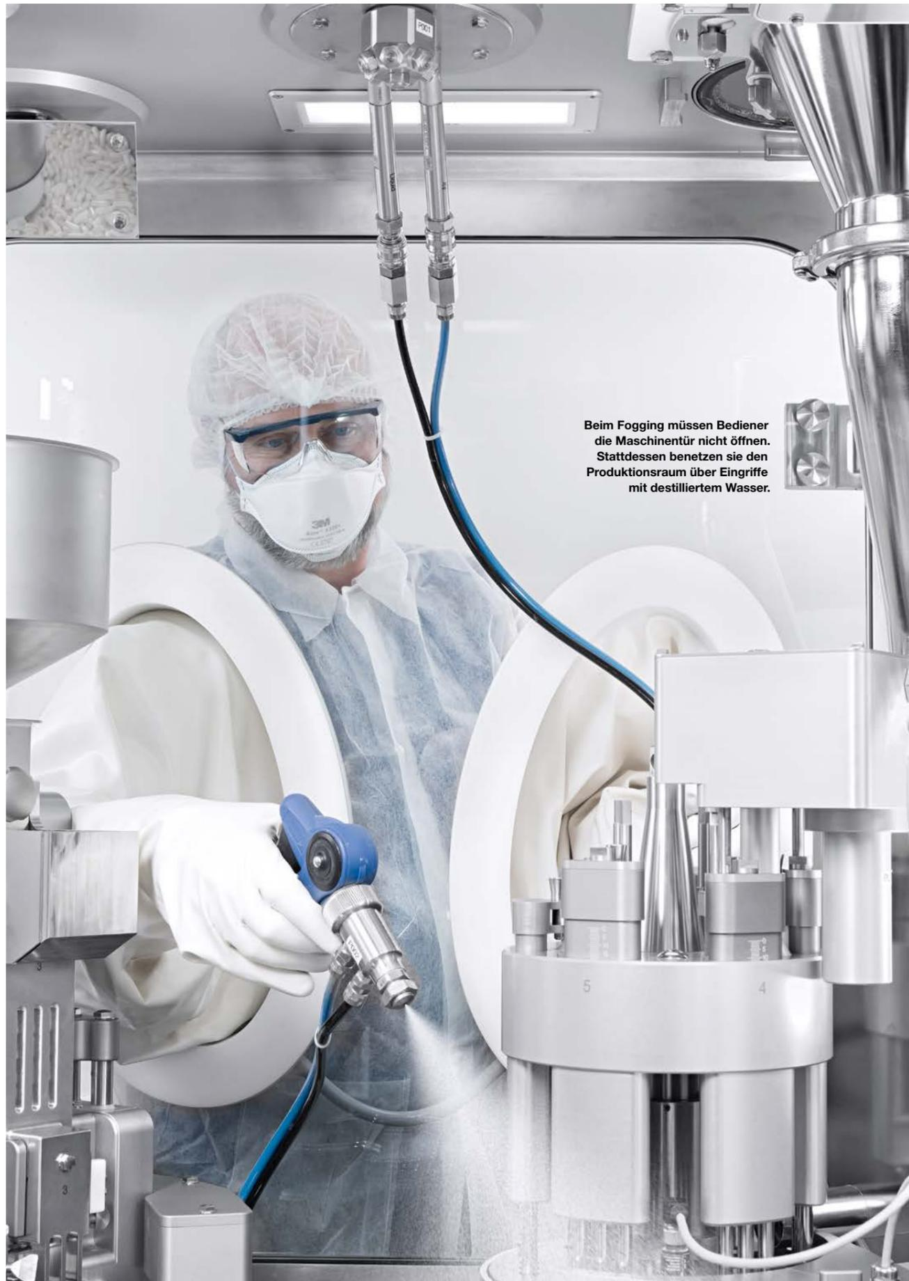
Beim Fogging müssen Bediener die Maschinentür nicht öffnen. Stattdessen benetzen sie den Produktionsraum über Eingriffe mit destilliertem Wasser.
