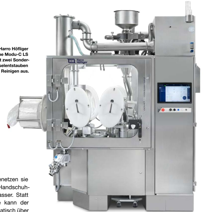
nicht öffnen. Stattdessen benetzen sie den Produktionsraum über Handschuh-eingriffe mit destilliertem Wasser. Statt über eine Handsprühpistole kann der Sprühnebel aber auch automatisch über Düsen im Innenraum erzeugt werden. Dabei wird Produktstaub gebunden. Anschließend kann das Containment zur eigentlichen Reinigung geöffnet werden, ohne dass Staub aufgewirbelt wird.“
